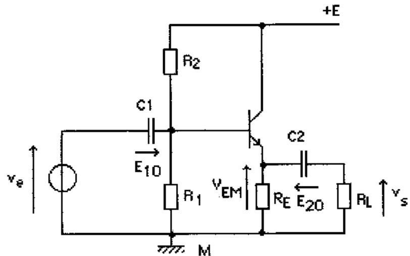
e- Exprimer littéralement  $v_s$  en fonction de  $v_e$  lorsque le transistor est conducteur.
