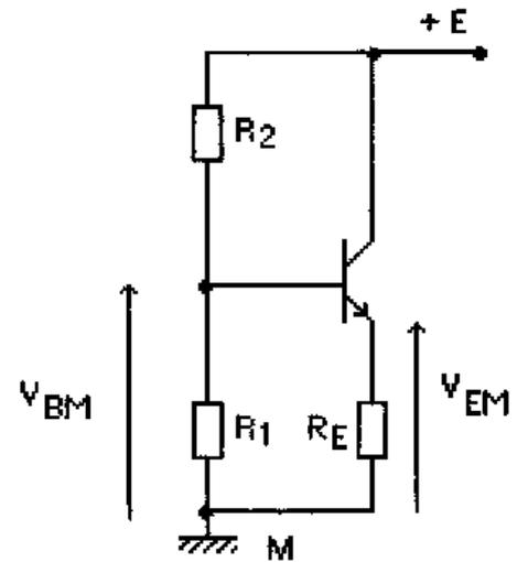
2- On complète le montage précédent pour l'utiliser avec un signal  $v_e$  alternatif. La résistance  $R_E$  est de 1 k $\Omega$  ;  $R_1$  et  $R_2$  permettent d'avoir au repos ( $v_e = 0$ ) :  $V_{EM0} = E/2$ . Les tensions aux bornes des condensateurs sont supposées constantes même en présence de signal.
